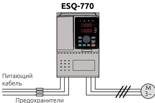
Рисунок 3-23. Схема установки предохранителей.
