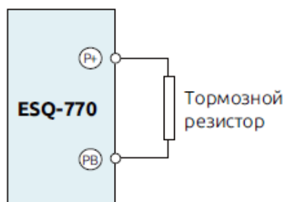
Рисунок 2-15. Подключение тормозного резистора к преобразователю мощностью до 75 кВт
